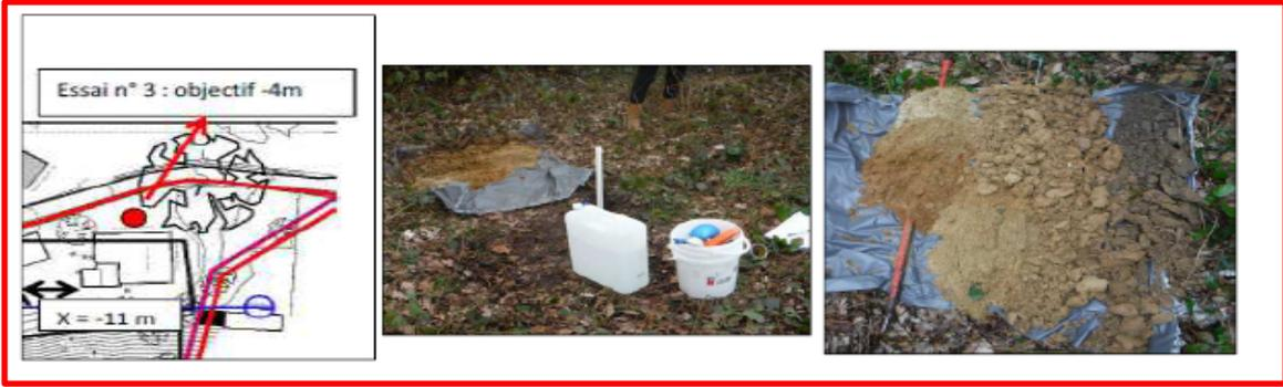
Après remplissage de la zone d'essai, le volume d'eau infiltré à charge constante, pour un pas de temps de 300 secondes, est mesuré dans le sondage. Les résultats obtenus sont repris dans le tableau et le graphique ci-dessous.
